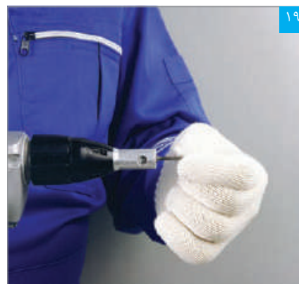
۱۹ برای نصب پنل‌ها از پیچ مخصوص و دستگاه پیچ زن استفاده می‌شود
