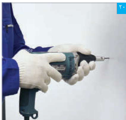
۲۰ نحوه صحیح در دست گرفتن پیچ زن (به صورت عمود بر پنل)
