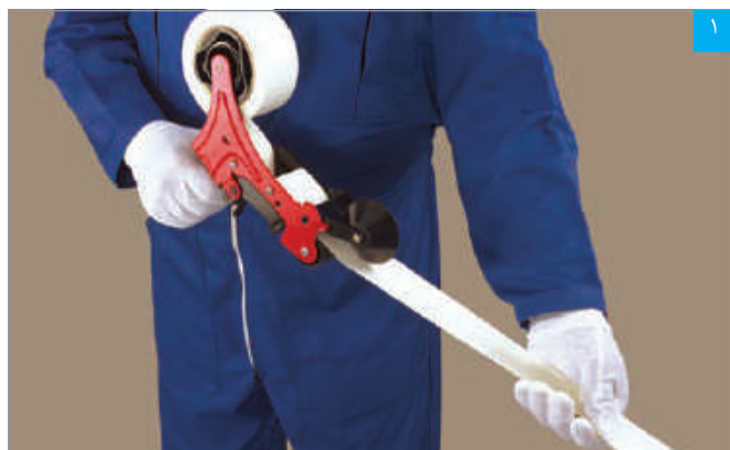
خم کردن نوار درزگیر با دستگاه تازن
